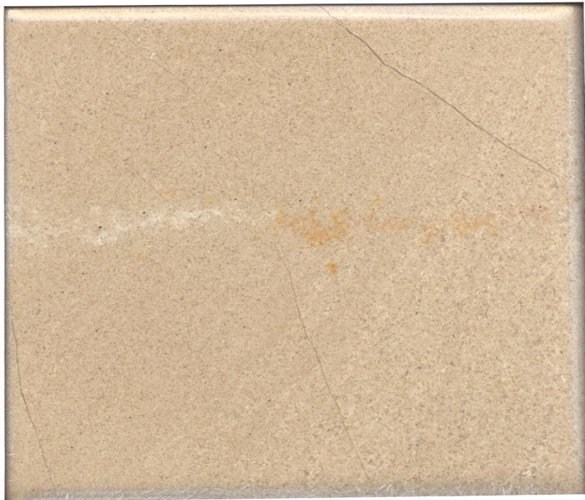
Mosaico que muestra buen corte y pulido y aristas sanas, con vetilleos de calcita y pequeñas impurezas de óxidos de fierro.
